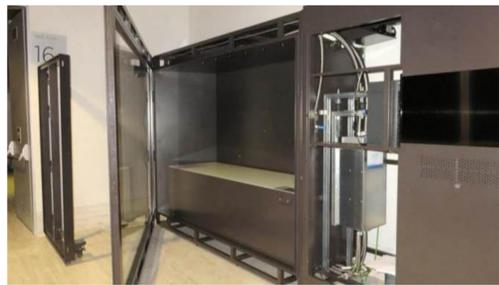
Este equipo, provisto de doble filtración de carbón activado, funciona en recirculación, trata los distintos compuestos orgánicos volátiles y mantiene las velocidades de aire y renovaciones en valores de diseño (0.1 m/s, 2 ren/h). [4].
